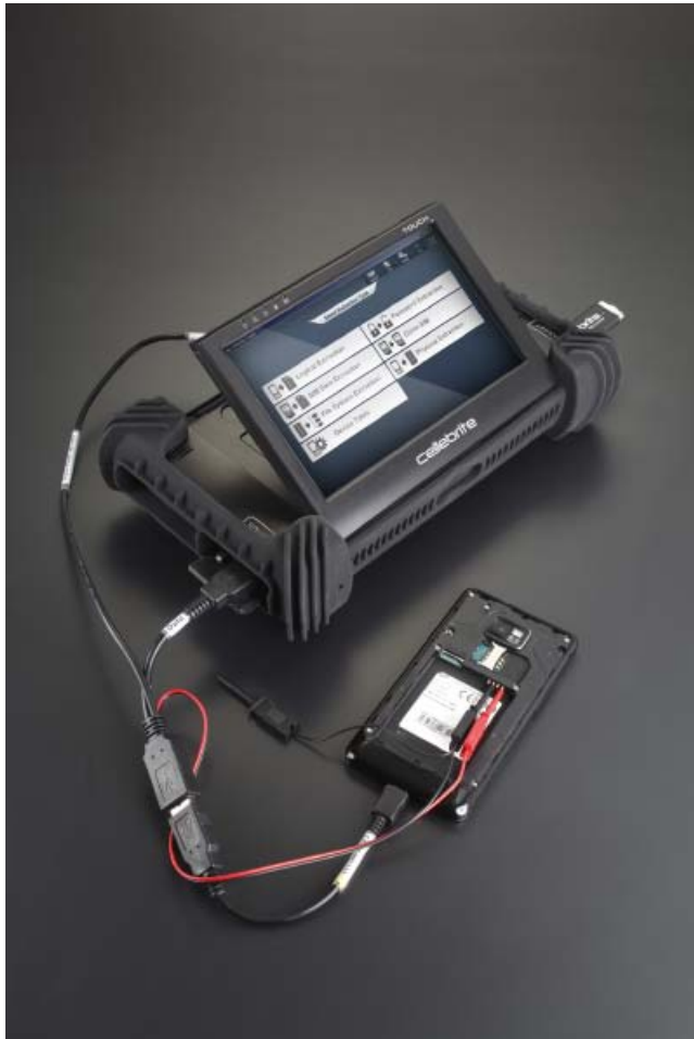
Abb.3: Extraktion mit dem UFED Touch™
